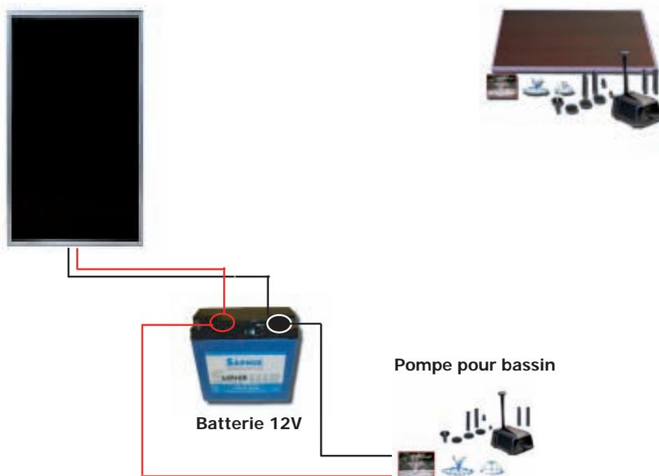
**Schéma de montage du kit pompe solaire 6W :**
