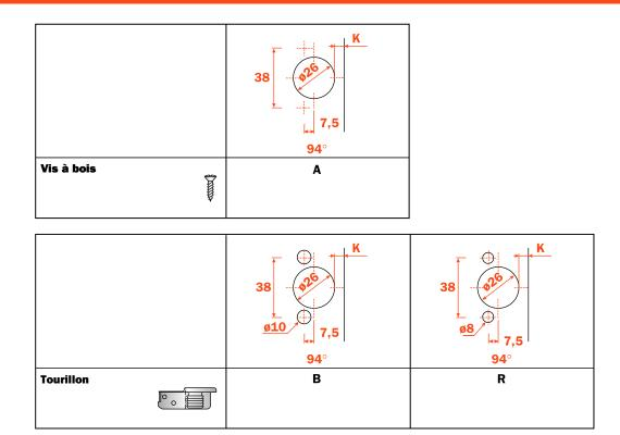
Utiliser les tableaux pour identifier les perçages et les fixations disponibles. Insérer en troisième position de la référence de la charnière, la lettre ou le numéro correspondant au choix fait. Exemple : C6\_7C99.
