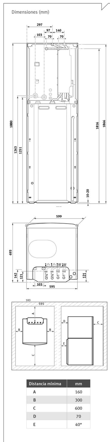
\* En caso de utilizar kit multizonas L11 (2 zonas de diferente temperatura) con el kit de conexiones, la distancia es de 160 mm.
