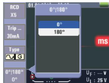
**Botón F1:** Menú de encendido y apagado RCD , el modo de apagado se activa cuando el usuario lo selecciona.
