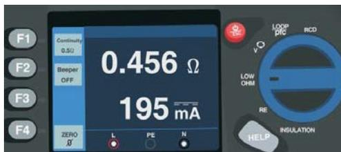
La prueba de continuidad se utiliza para verificar la integridad de las conexiones haciendo una medición de la resistencia de alta resolución. Esto es especialmente importante para el control de la protección de las conexiones a tierra .
