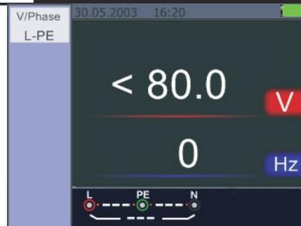
Figure 19 Pantalla de espera para el voltaje y frecuencia
