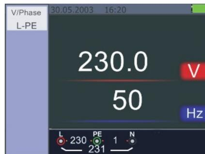
Figura 20 Pantalla mientras que la medición de voltaje y frecuencia
