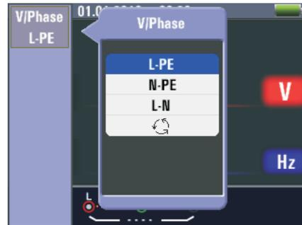
**Botón F1:** Encendido y apagado del voltaje / menú fase, modo de apagado se activa cuando el usuario lo selecciona.
