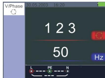
Figura 23 Fase pantalla cuando la secuencia conectada en sentido horario.
