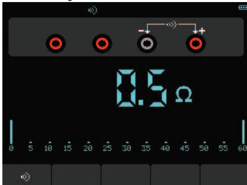
Figura 4-4: Test de continuidad
