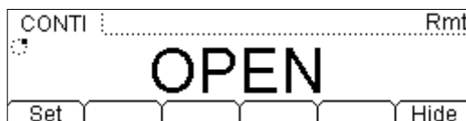
Figura 2-27 Interfaz de la comprobación de continuidad
