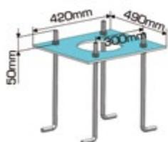
Le gabarit reste en place de niveau et doit reposer entièrement sur massif béton. Entaxe tiges de scellement 300 x 300 mm.
