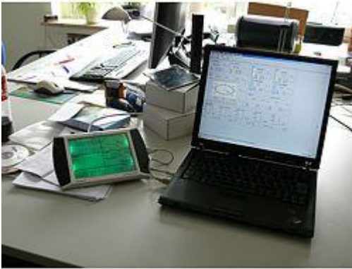
Aquí observa la estación meteorológica PCE-FWS 20 conectado a un portátil con el software
