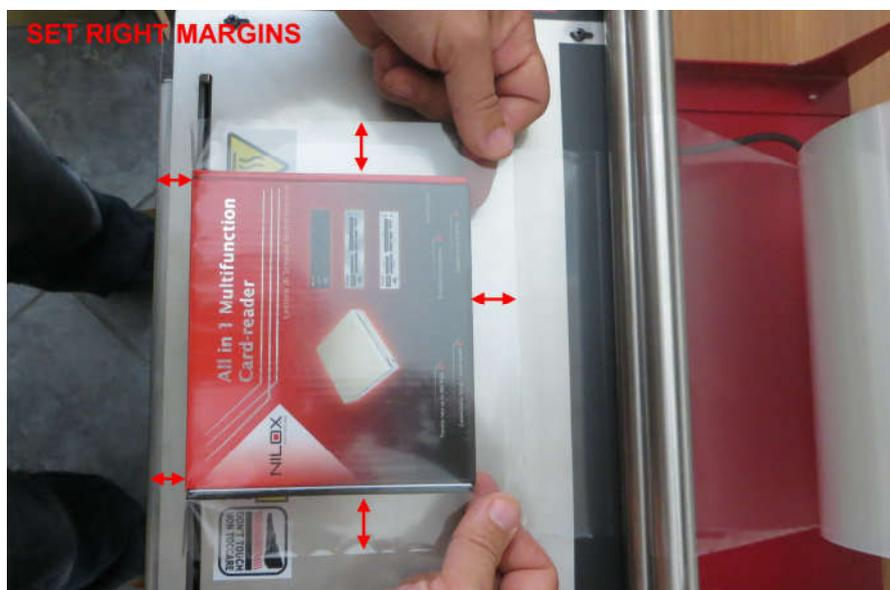
**2- EJECUCIÓN DEL PRIMER FRENTE DE SOLDADURA: doble el exceso de celofán delantero en el costado de la caja y manténgalo adherido al apretarlo con los dedos a la izquierda y a la derecha como se muestra en la foto, el frente debe estar libre para soldar.**
