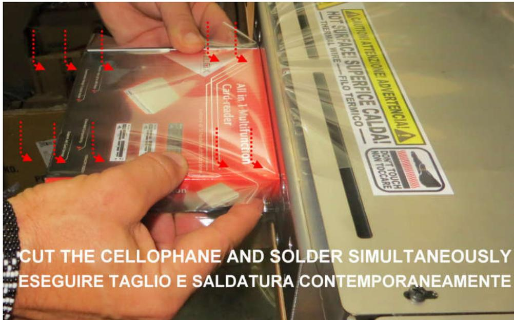
**5- SOLDADURA LATERAL:** doblar el celofán internamente y luego con otros 2 dedos doblar una solapa hacia abajo como se muestra en la imagen. preparar los pliegues al máximo con los dedos como una bolsa de regalo te ayudará a obtener buenas soldaduras.
