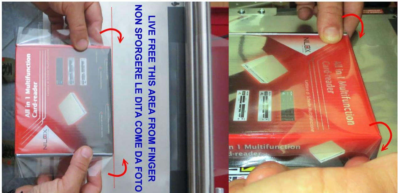
**3- MANTENIENDO AL CELOFANO PLEGADO CON LOS DEDOS, TRANCHALO CON LA CAJA y calcule un exceso de celofán suficiente para hacer un corte adecuado para la soldadura frontal.**
